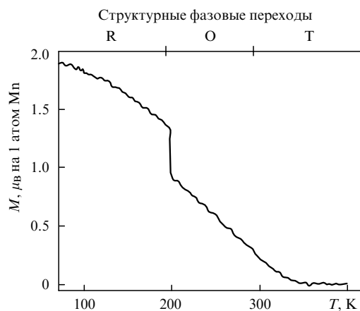
Рис. 7. Температурная зависимость намагниченности эпитаксиальной пленки \text{La}_{0.67}\text{Sr}_{0.33}\text{MnO}_3 на подложке \text{BaTiO}_3 . 31
